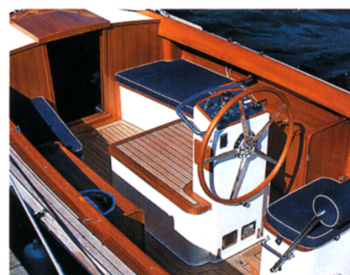
Träarbetet är gediget. Även detaljer som luckorna känns gedigna. De består av fanér med Divinycell som distansmaterial.
